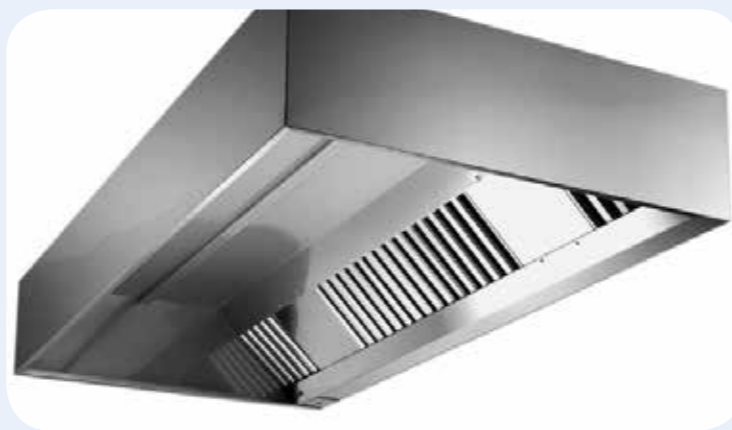
CAPPE A PARETE Costruzione in acciaio inox aisi 304. Dotata di 4 filtri da 400x500 mm. Portata indicativa di circa 3000 M 3 /h. Dimensioni LxPxH: 1400x2000x500 mm.
