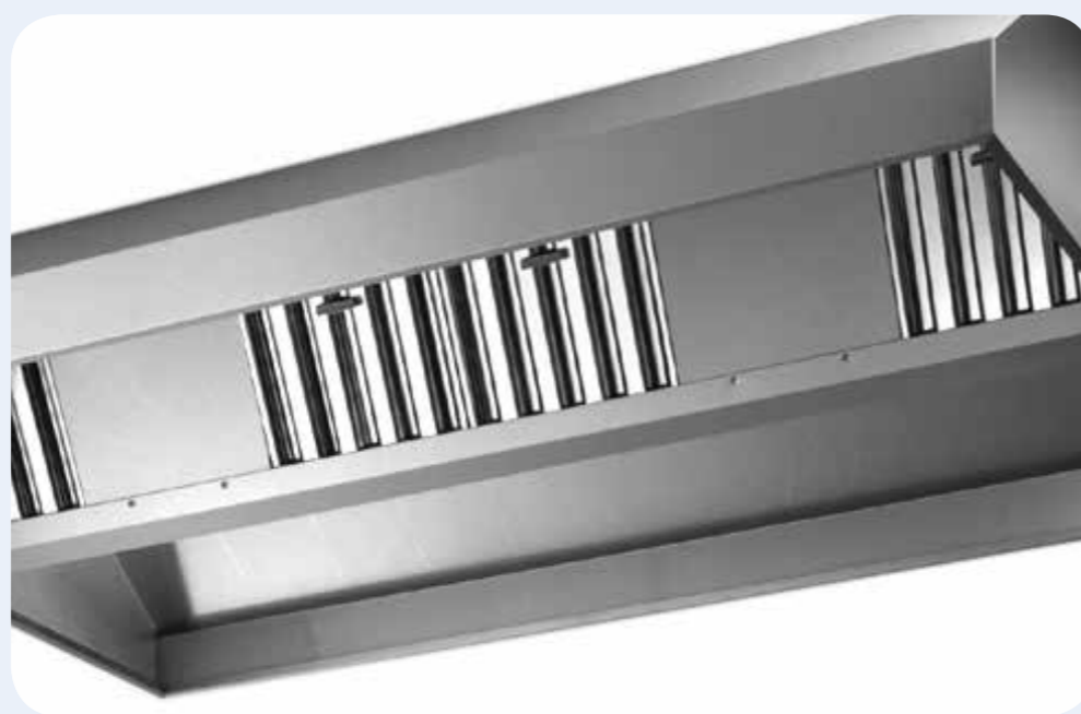
CAPPE A PARETE Costruzione in acciaio inox aisi 304. Dotata di 4 filtri da 400x500 mm. Portata indicativa di circa 3000 M 3 /h. Dimensioni LxPxH: 1400x2000x500 mm.
