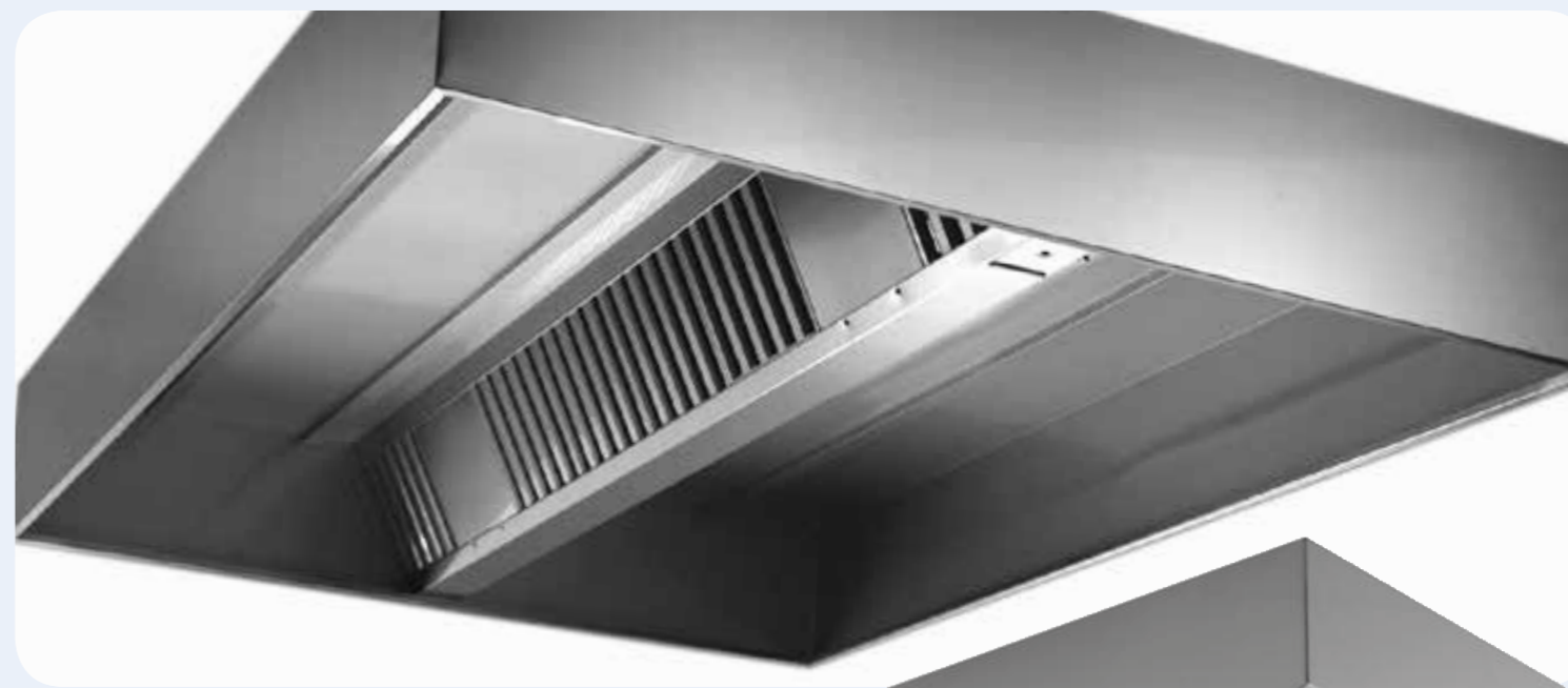
CAPPE CENTRALI Costruzione in acciaio inox aisi 304. Dotata di 8 filtri da 400x500 mm. Portata indicativa di circa 5000 M 3 /h. Dimensioni LxPxH: 2200x2000x500 mm.
