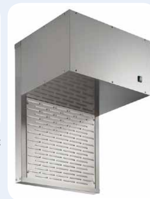
CAPPE PER LAVASTOVIGLIE Costruzione in acciaio inox aisi 304. Portata indicativa di circa 700 M 3 /h. Dimensioni LxPxH: 660x570x900 mm.
