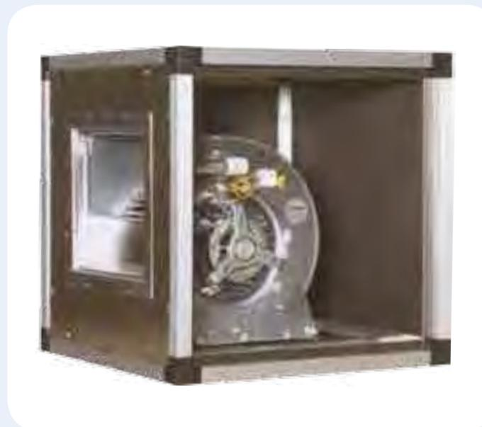
**UNITÀ DI ESTRAZIONE** Ventilatore centrifugo a doppia aspirazione con girante a pale in avanti staticamente e dinamicamente equilibrata. Trasmissione con pulegge e cinghie.
