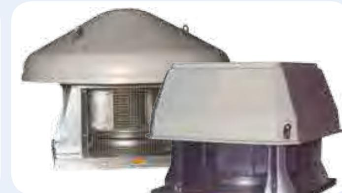
**TORRINI DI ESTRAZIONE** Getto orizzontale. Costituiti da parapioggia in ABS, base e supporti in lamiera zincata, ventola di aspirazione e motore direttamente accoppiati con ventilazione esterna. Costruzione in acciaio inox aisi 304. Portata indic. M<sup>2</sup>/h: 5500. Potenza motore 1,2 - 0,6 Kw
